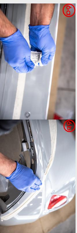
7) Umieść dokładkę, we wcześniej zaznaczonym miejscu i odklej folię zabezpieczającą taśmę, pamiętaj aby odklejać folię stopniowo jednocześnie dociskając dokładkę oraz uważając aby jej nie przesunąć 7a i 7b.
